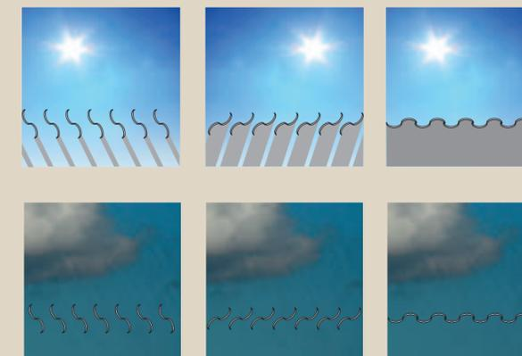
En position ouverte ou semi-ouverte, la circulation de l'air entre les lames évite l'effet de serre tout en gardant un espace ombragé. L'air ambiant est ainsi renouvelé et rafraîchi. En cas de pluie, les lames de la pergola peuvent être complètement fermées, l'espace créé reste fonctionnel quel que soit le temps.
