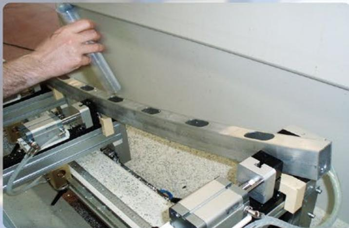
Centre d'usinage : permet de fraiser jusqu'à 6 mètres de profilés en aluminium, à l'unité ou en plusieurs séries
