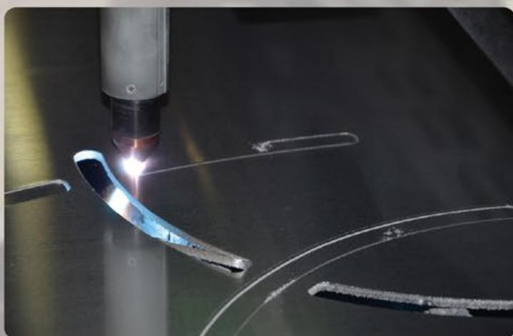
Découpeuse Plasma : découpe de tôles en aluminium jusqu'à 15 millimètres d'épaisseur
