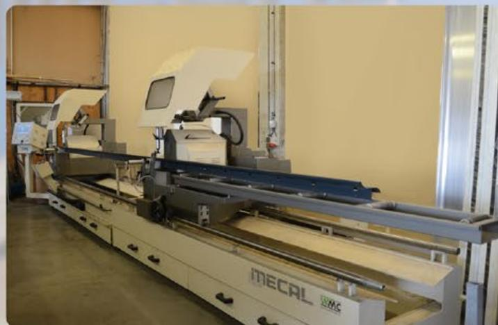
Tronçonneuse double : découpe de profilés en aluminium jusqu'à 15 mètres de longueur, avec des angles de 20 à 160 degrés
